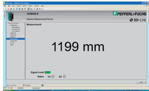
通過IO-Link Master控制模塊，即可方便的進行參數設定及距離監控
