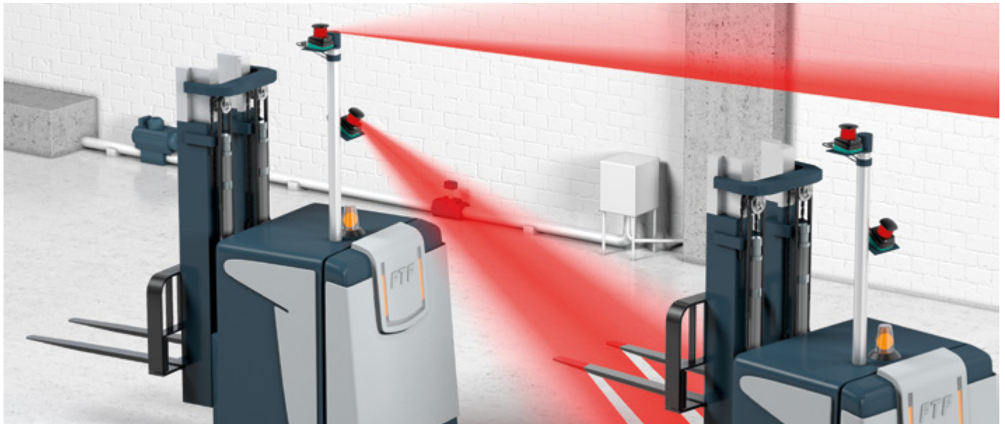
Der R2000 UHD liefert Distanz-, Winkel- und Echoinformationen zur Navigation des FTFS
